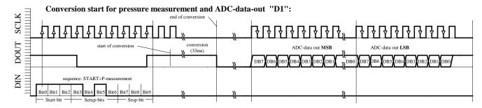
Fig. 6a: D1 ACQUISITION sequence
